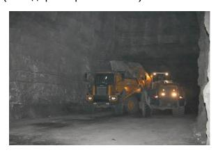
Произведено техническое перевооружение гипсового комбината и в первую очередь третьего ствола диаметром 8 метров. Тем самым стало возможным спускать под землю крупногабаритное оборудованиесамосвалы, буровое оборудование на глубину более 130 метров.
